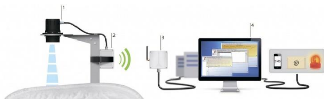
Рис.3. Состав системы измерения снежного покрова.
